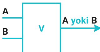
3-rasm. "YOKI" mantiqiy elementi
