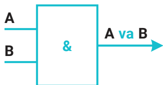
1-rasm. "VA" mantiqiy elementi
